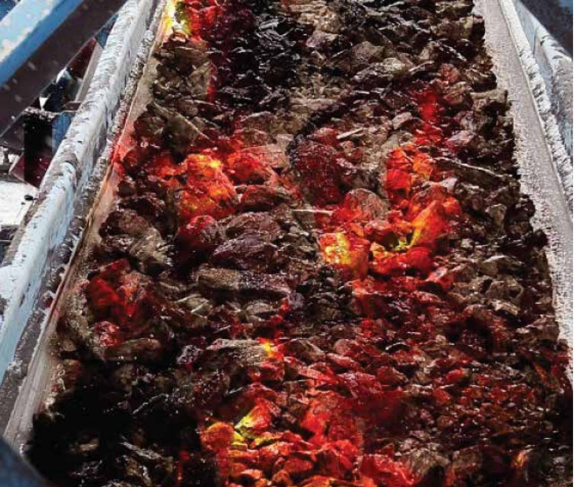
EPDM esaslı maks. 180° C sıcaklığındaki malzemelerin nakledilmesinde kullanımı uygun olan bant lastiğidir. Kapak kauçuğu, yüksek yapışma mukavemeti ve mükemmel termal koruma sağlamaktadır.
